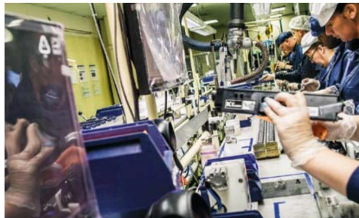
Im Reinraum werden die Cartridges überprüft, instandgesetzt und neu befüllt.
